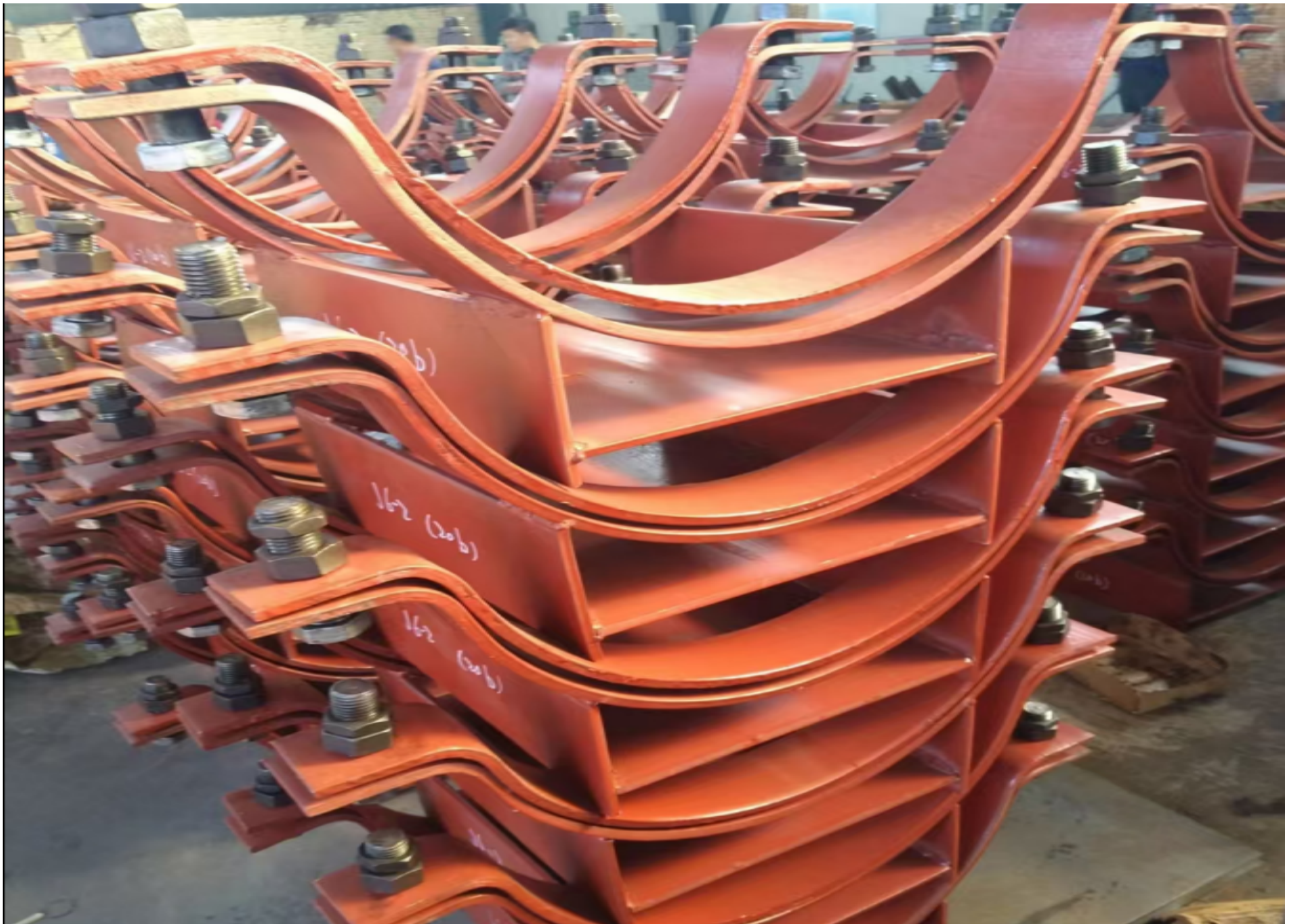
支架加工 · Support Fabrication
