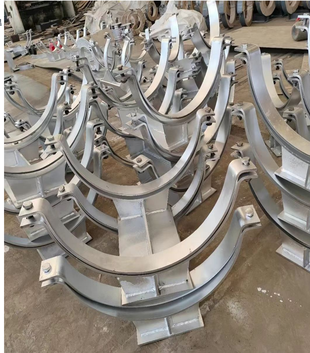
支架加工 · Support Fabrication
