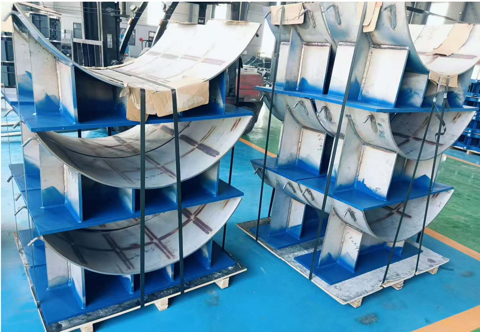
支座加工实景 · Support Fabrication
