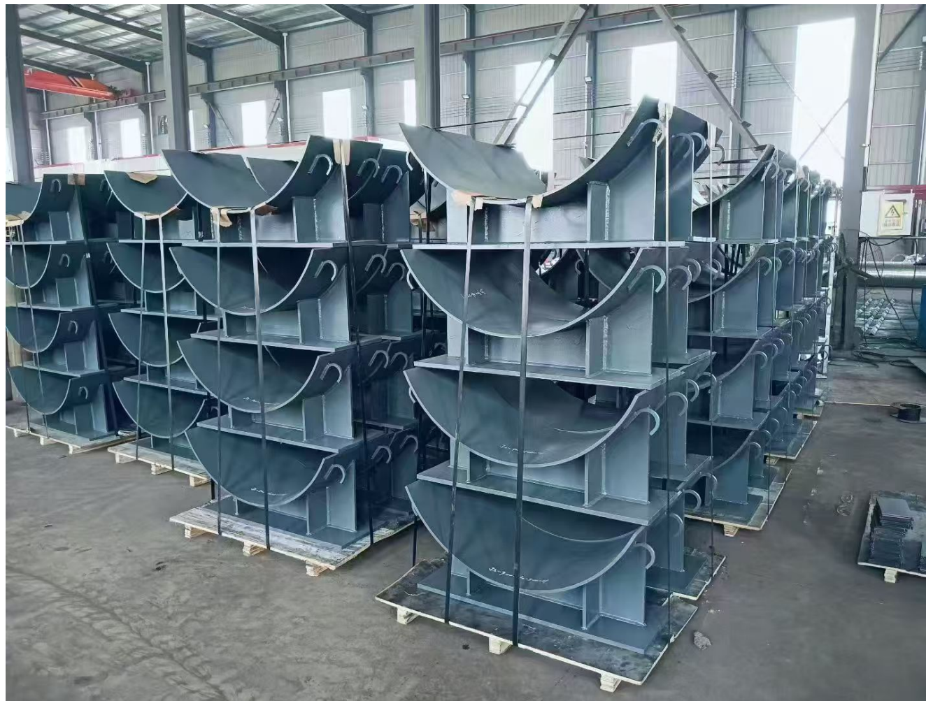
支座加工实景 · Support Fabrication
