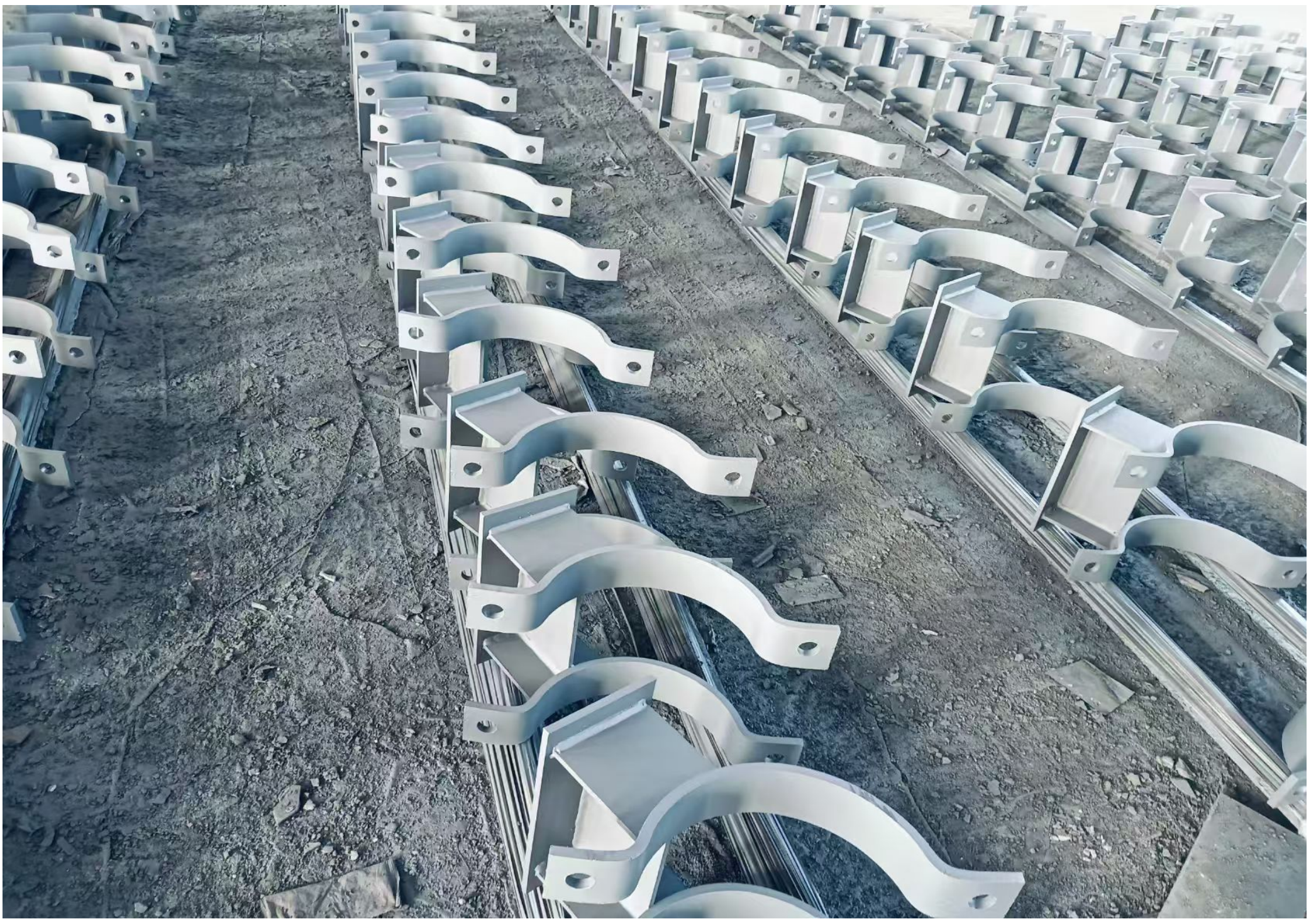
支架加工 · Support Fabrication
