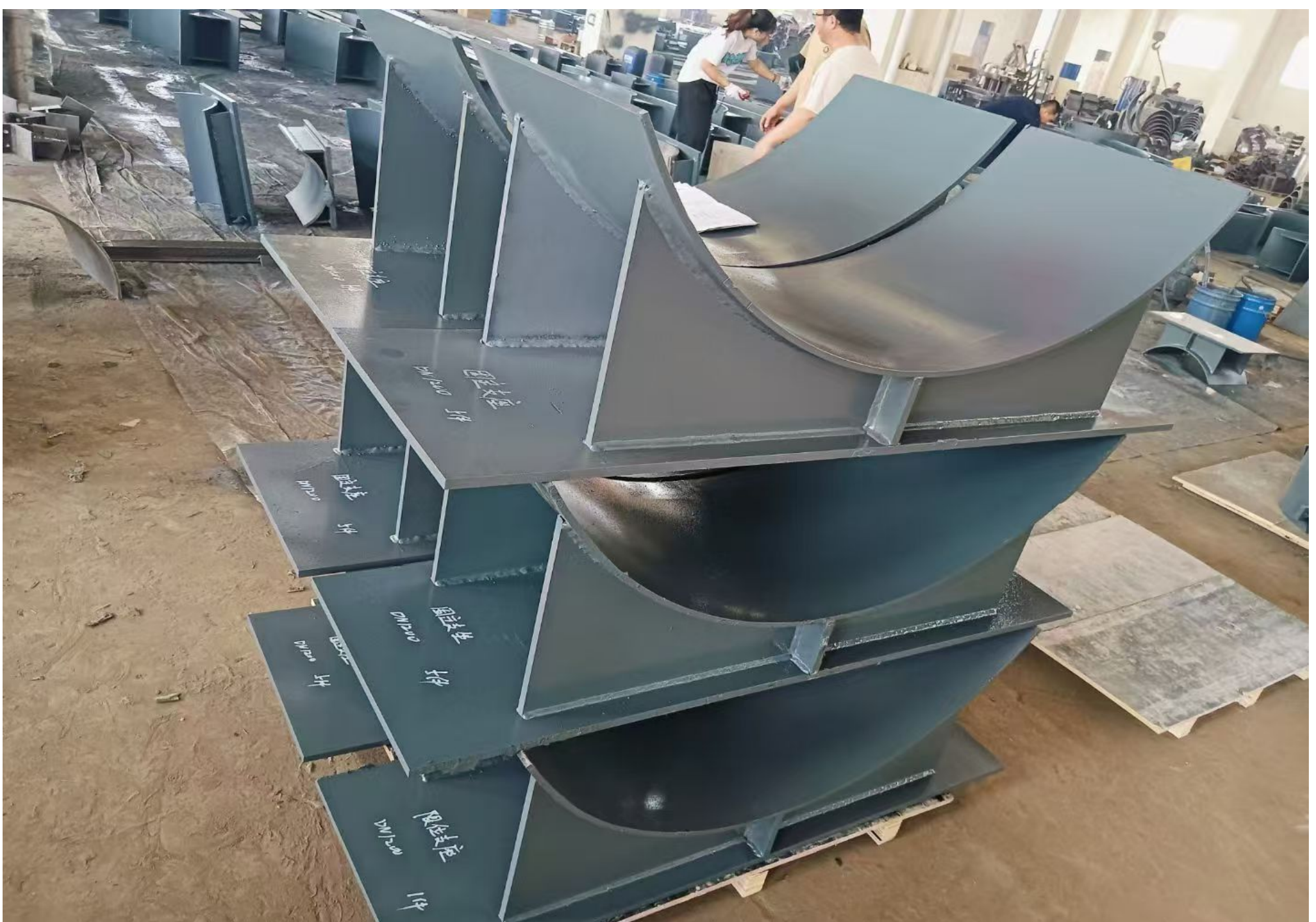
支座加工实景 · Support Fabrication
